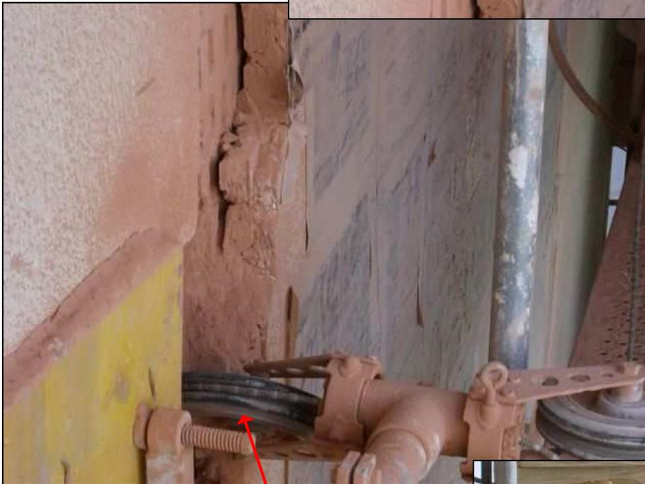
*Schneidegerät: Seilführung über Umlenkrollen*
